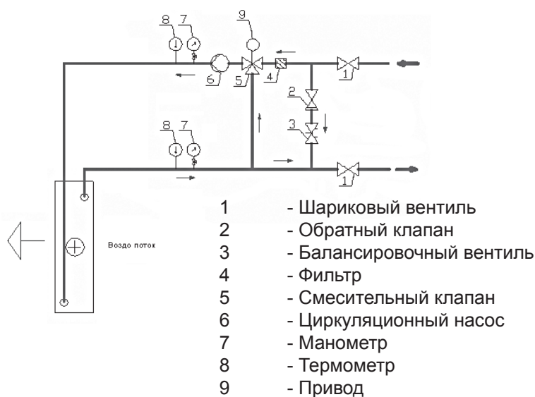
Монтажная схема
